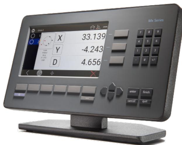
Affichage : LCD couleur 7" 1024 X 600, avec écran tactile capacitif rétroéclairé par LED.
